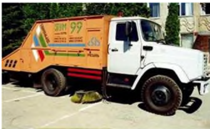
Рисунок 6.13 Вакуумная подметально-уборочная машина ПУМ-99 на базе шасси «ЗИЛ»
