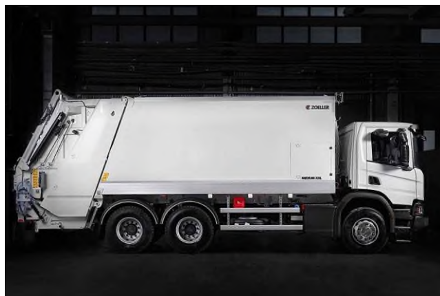
Рисунок 4.34 Мусоровоз с задней загрузкой SCANIA P360 серии MEDIUM XXL
