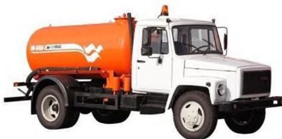
Рисунок 5.3 Вакуумная машина КО-503В-2 на шасси ГАЗ-3309
