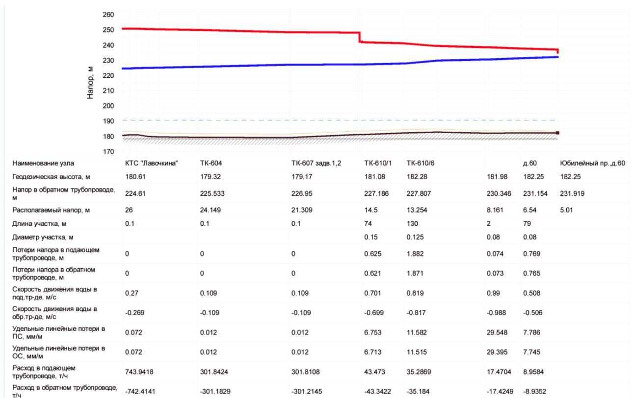
Рисунок 3 - Пьезометрический график
