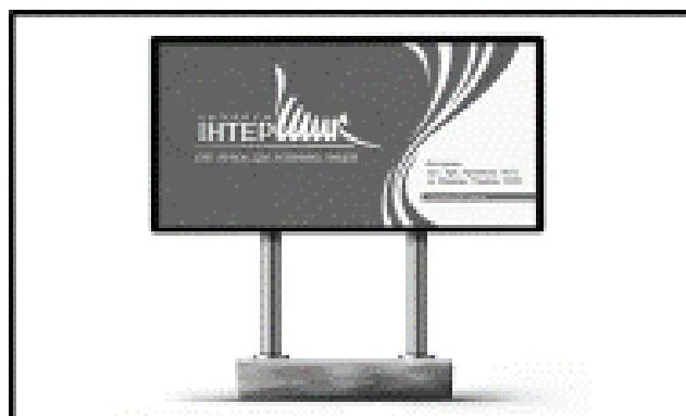
Рекламный щит размерами XXXX на XXXX предполагается выполнить на бетонном основании (фундамент), опоры металлические трубы диаметром XXX, рекламная поверхность металло каркас обшитый профлистом.
