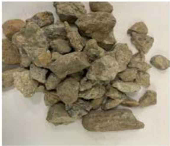
Рисунок 3 – Щебень вторичный с размером фракции 20-40 мм
