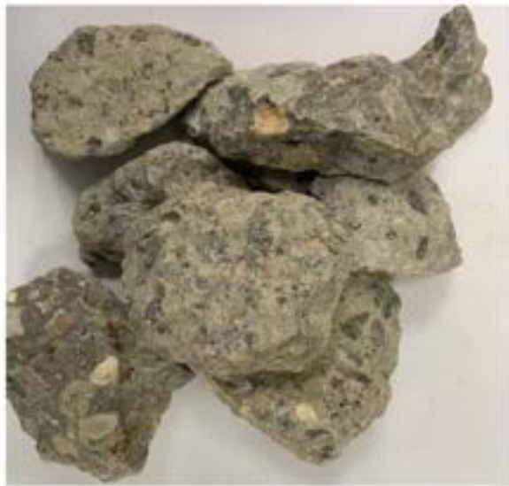
Рисунок 3 – Щебень вторичный с размером фракции 20-40 мм
