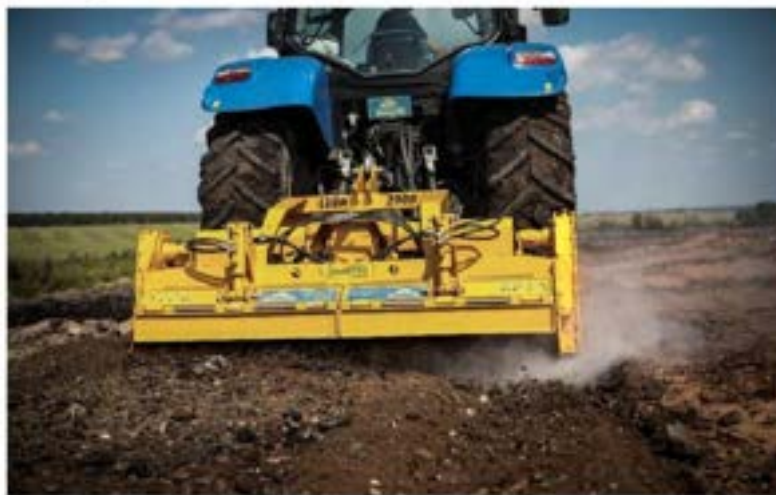
Рисунок 18 – Смешение/измельчение исходных компонентов с помощью ротораторной установки Valentini Leon 2000
