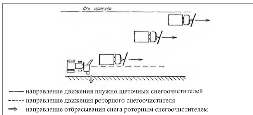
Рисунок 6.6 Схема расчистки проезжей части улиц колонной плужно-щеточных снегоочистителей и перекидывание снега роторным снегоочистителем
