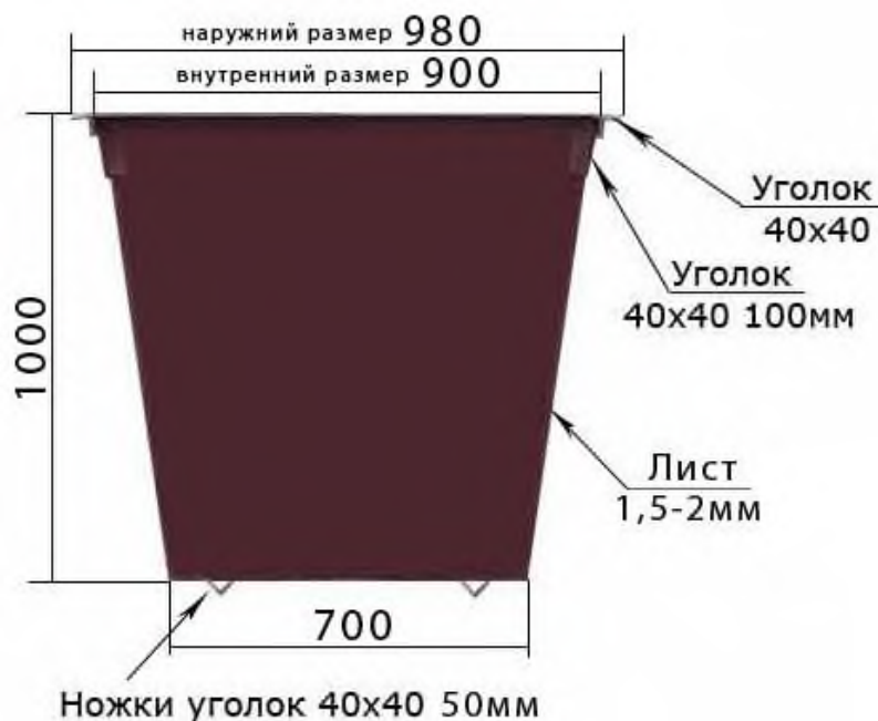
Рисунок 4.16 Стандартные металлические контейнеры емкостью 0,75 м 3
