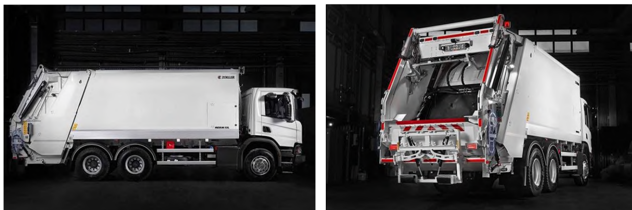
Рисунок 4.34 Мусоровоз с задней загрузкой SCANIA P360 серии MEDIUM XXL
