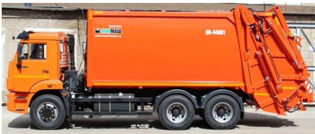
Рисунок 4.36 Мусоровоз с задней загрузкой КО-440В на базе шасси КАМАЗ 53605
