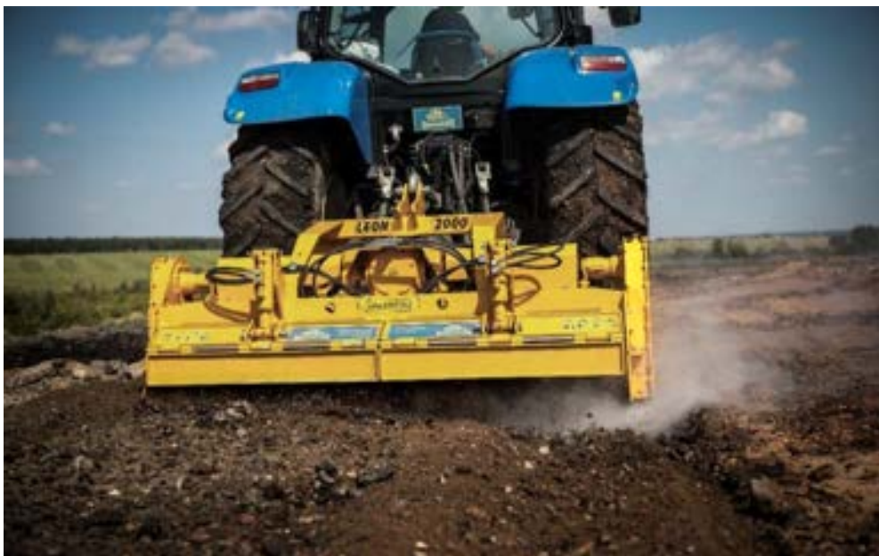
Рисунок 18 – Смешение/измельчение исходных компонентов с помощью роторной установки Valentini Leon 2000
