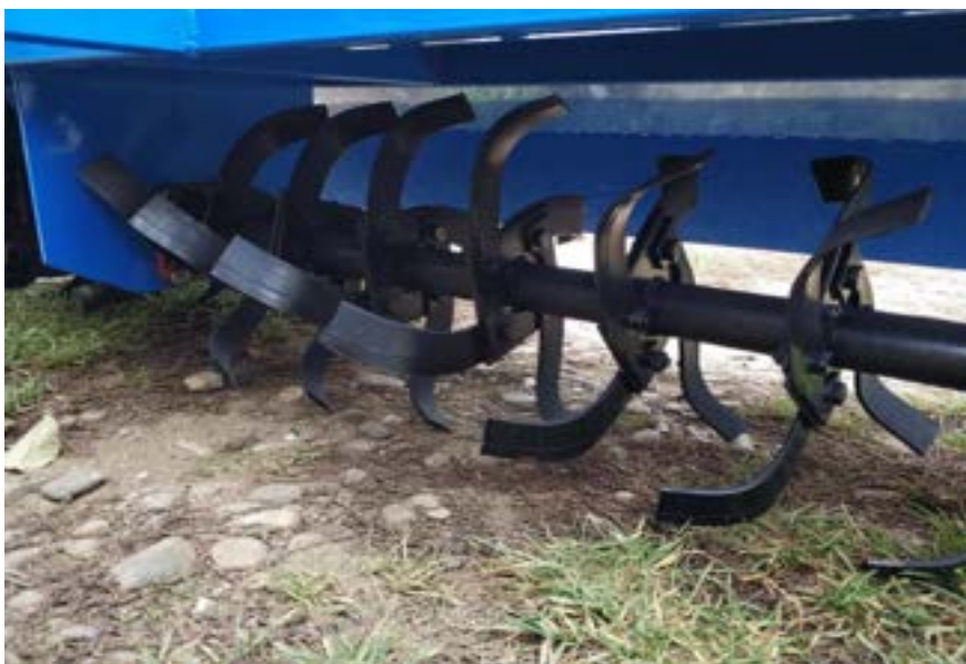
Рисунок 19 - Смешение исходных компонентов с помощью почвофрезы
