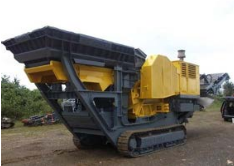
Рисунок 16 – Мобильная щековая дробильная установка HARTL PC1265J
