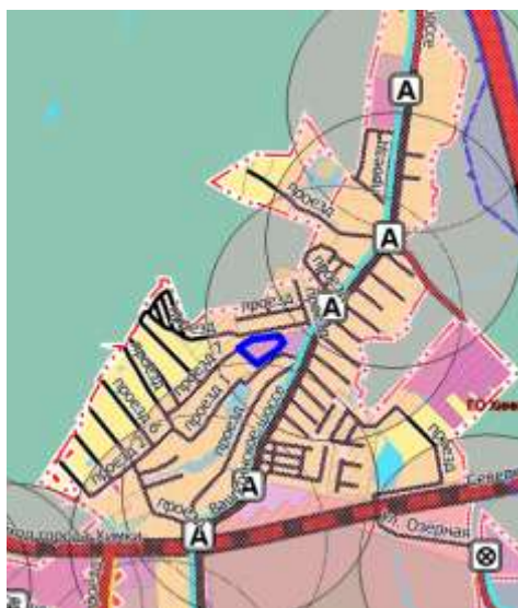
Рис. 3.5.2.5.1.1. Схема сети маршрутов регулярных пассажирских перевозок с радиусами нормативной обеспеченности пешеходного подхода до остановки общественного транспорта 500м.
