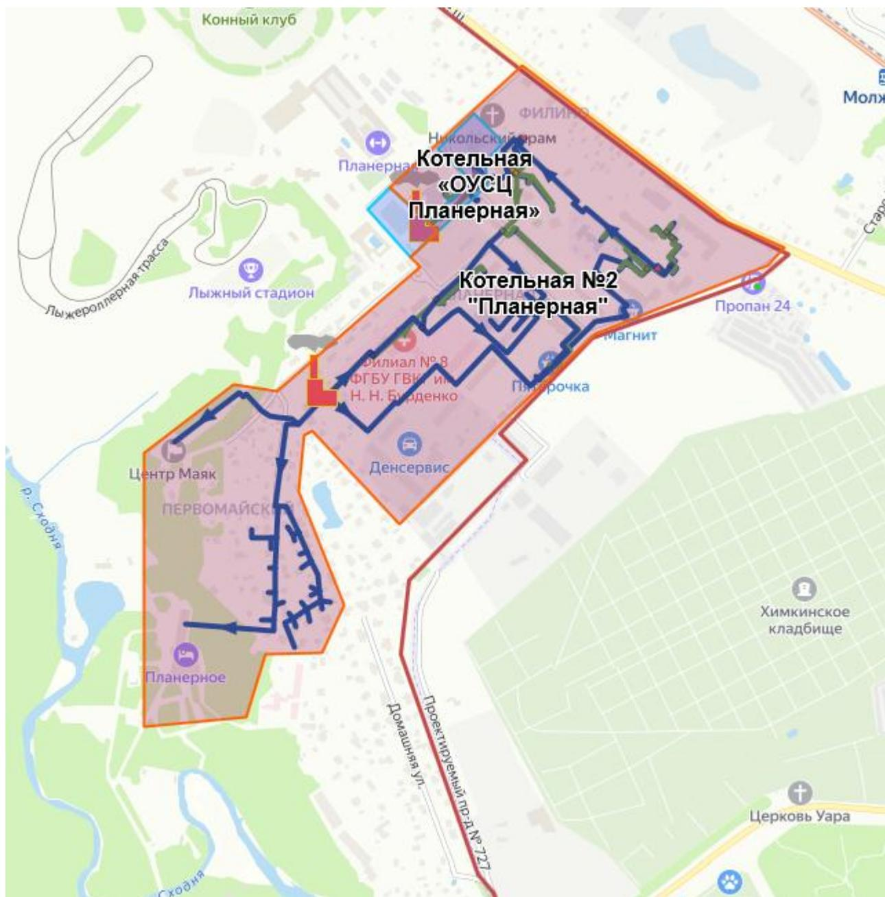
Рисунок 1.3.2.7 – Схемы тепловых сетей от котельной «ОУСЦ Планерная» и котельной №2 «Планерная»
