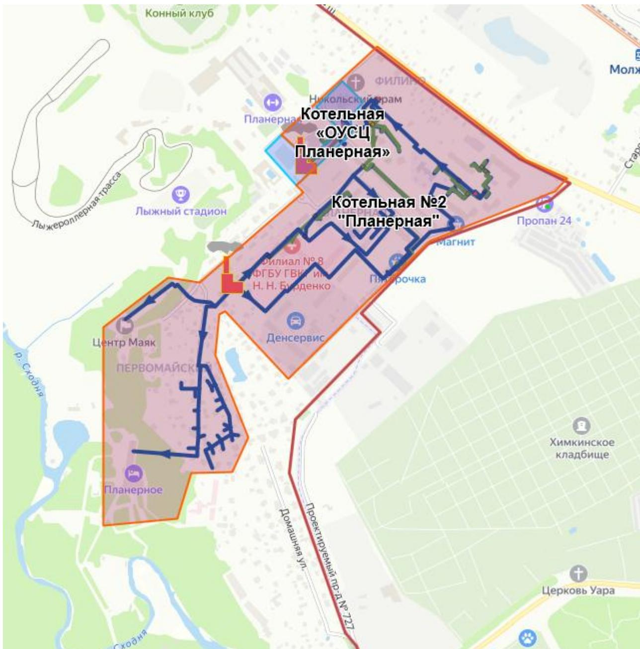
Рисунок 1.1.3.7 – Зона действия котельной «ОУСЦ Планерная» и котельной №2 «Планерная»
