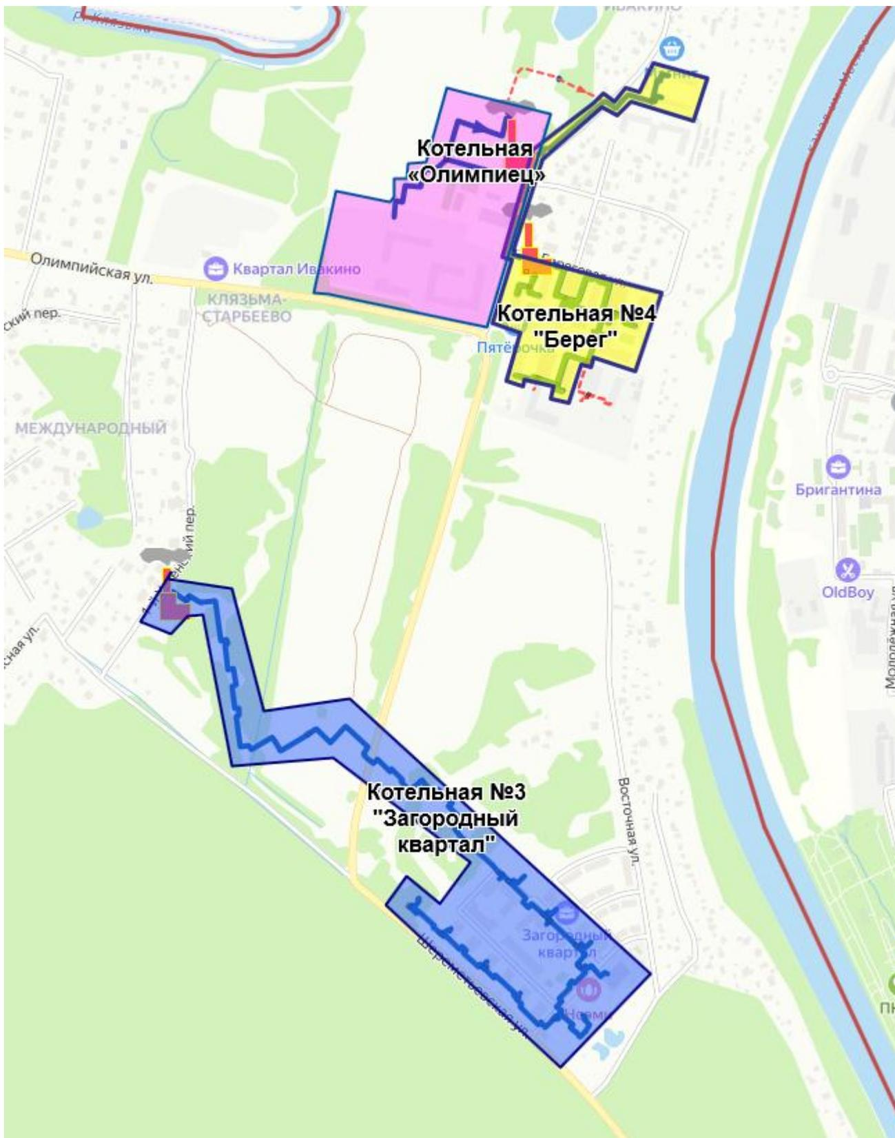
Рисунок 1.3.2.6 – Схемы тепловых сетей от котельных, осуществляющих централизованное теплоснабжение в мкр. Клязьма-Старбево
