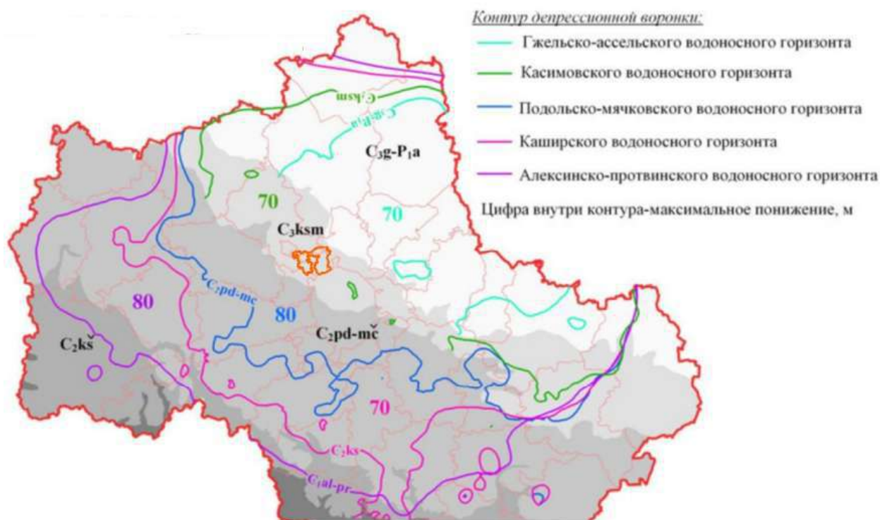
Рисунок 1.3.3. Распространение депрессионных воронок по основным эксплуатационным водоносным горизонтам каменноугольных отложений Московской области
