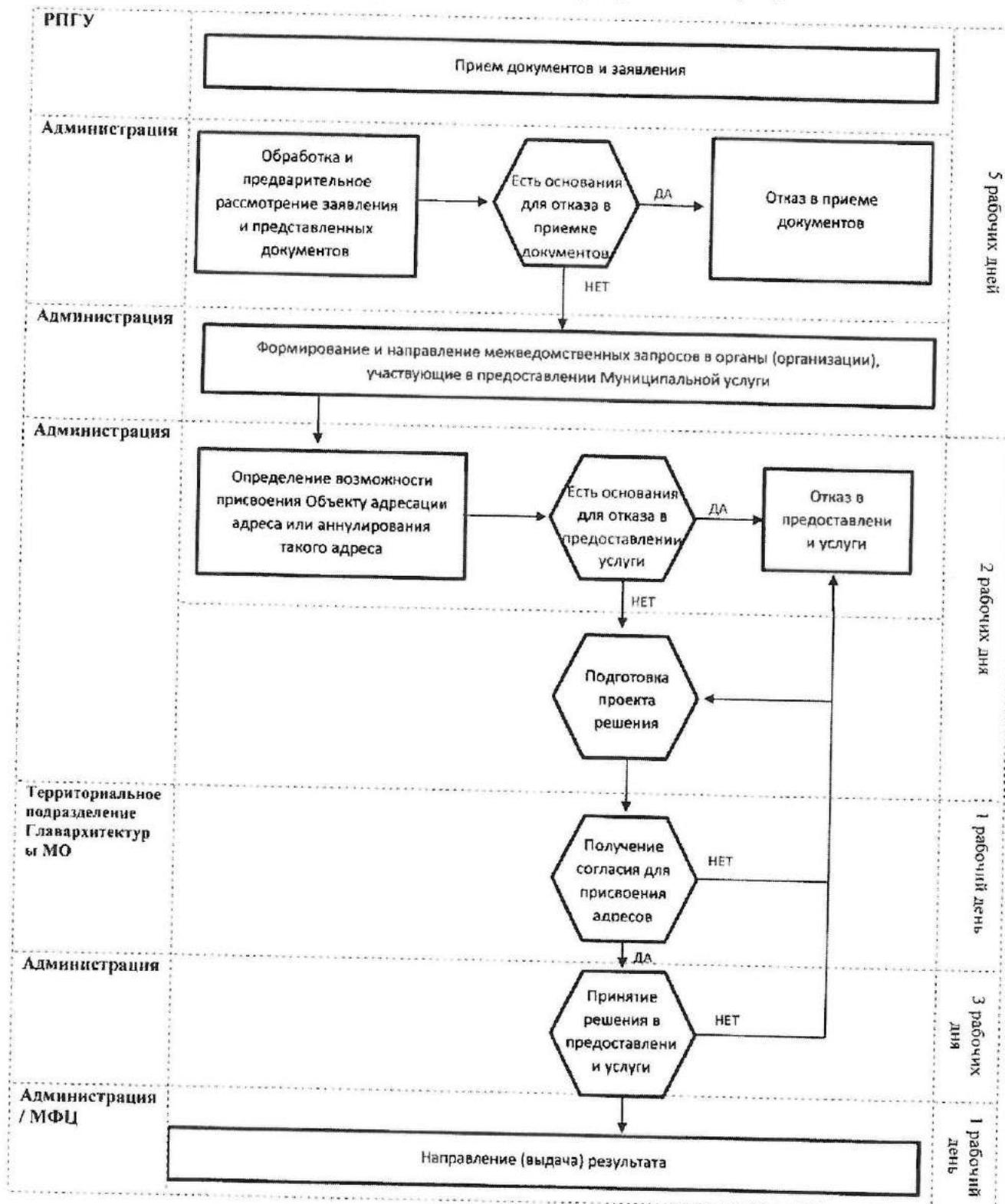
**БЛОК СХЕМА ПРИСВОЕННИЯ АДРЕСА ОБЪЕКТУ АДРЕСАЦИИ
