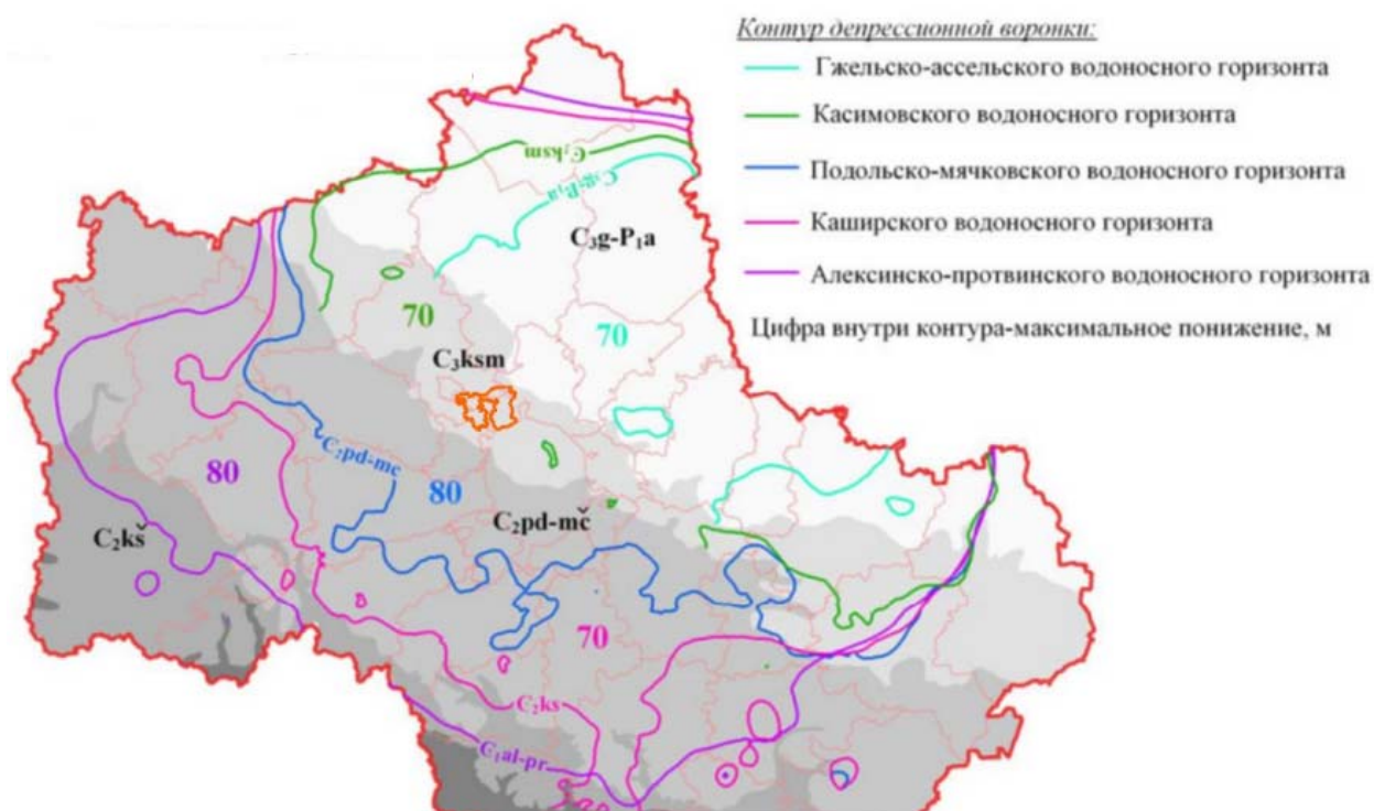
Рисунок 1.3.3. Распространение депрессионных воронок по основным эксплуатационным водоносным горизонтам каменноугольных отложений Московской области
